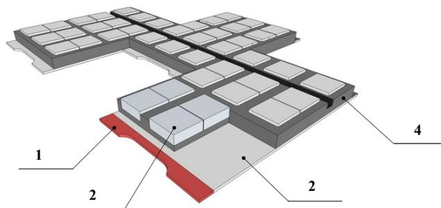
Рис. Сегментная футеровка
