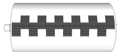
3. По нанесенной линии приварить сегмент к барабану. Приваривать сегмент к поверхности барабана необходимо в области специальных «ушек», которыми снабжен сегмент
