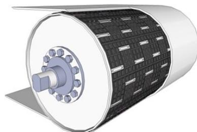
Для барабанов диаметром <math><400\text{ мм}</math> рекомендуется применять сегменты шириной 157 мм.
