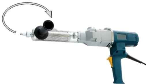
Разогреть экструдер таким образом, пока защитная сетка вокруг шнека не нагреется до теплого ощущения в руке.
