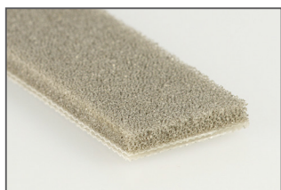
PU foam, grey Polyurethane foam
