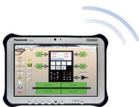
Опционально мы можем предложить электронный планшет промышленного исполнения (ударопрочный, водо- и пыленепроницаемый) с установленным программным обеспечением Splice Watch.
